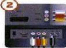
2 Подключите антенный кабель к антенному входу цифровой приставки. Подключите видео- и аудио кабели к соответствующим разъемам на телевизоре и цифровой приставке
