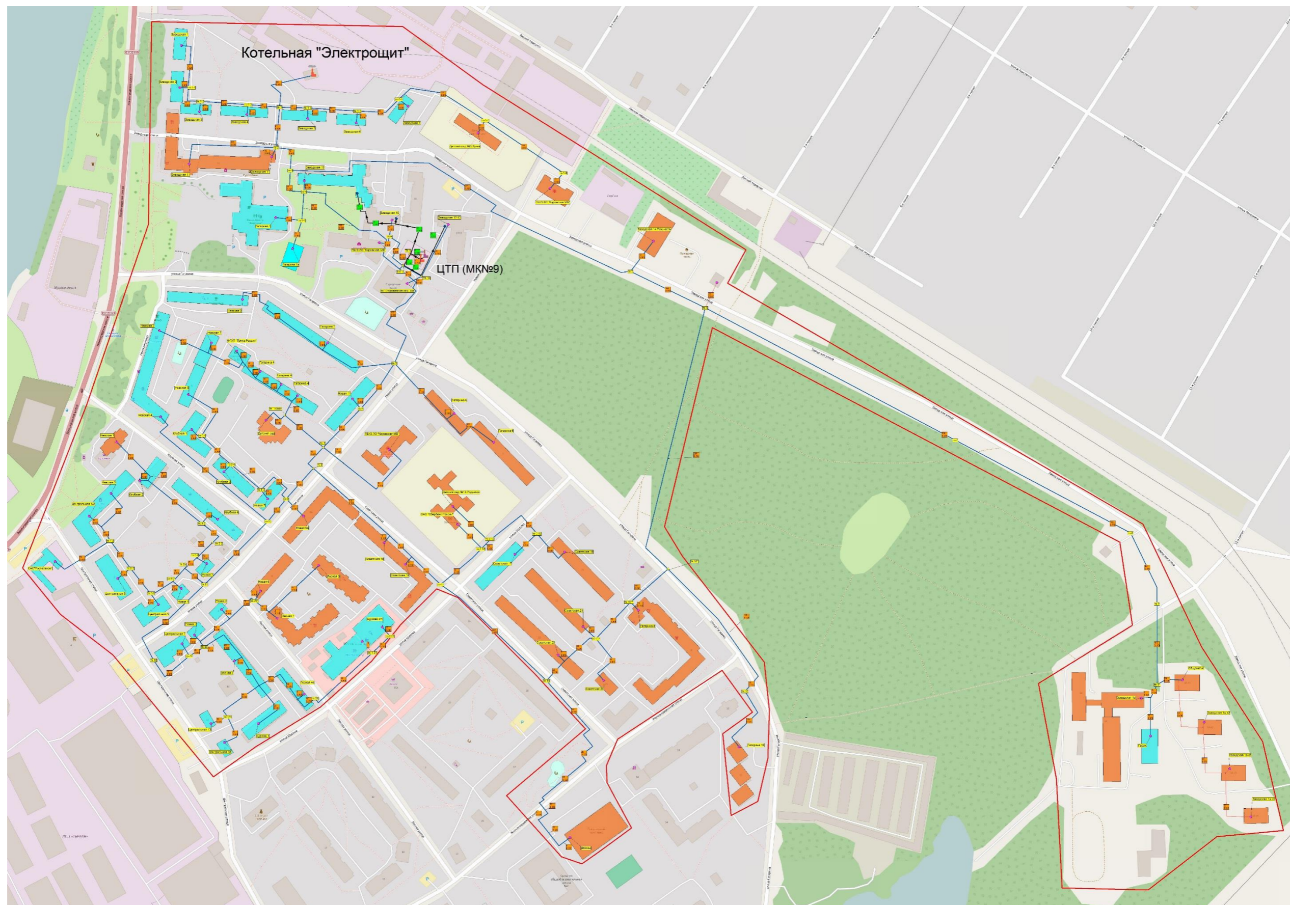
Рисунок 3. Схема тепловых сетей от котельной «Электрощит» с ЦТП.
