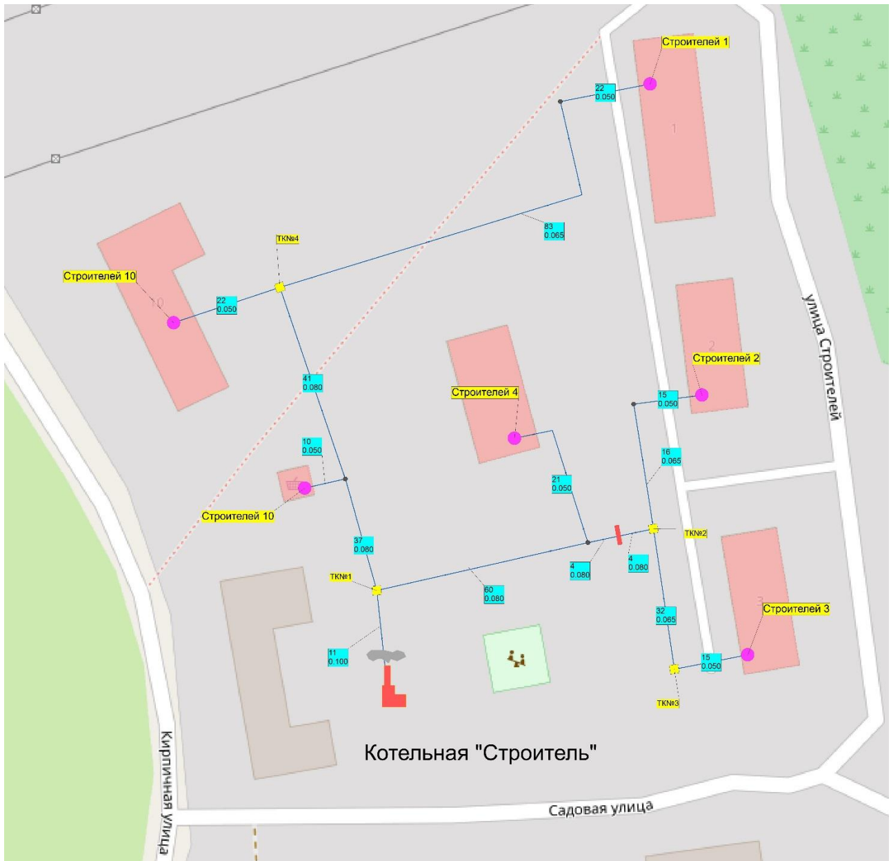
Рисунок 9. Тепловые сети от котельной «Строитель».
